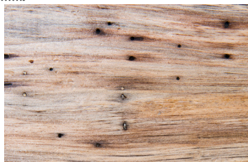
INSECT HOLES (pin holes)
